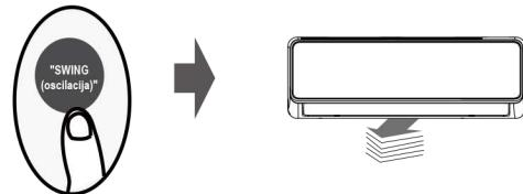
Ako nastavite pritiskati tipku "SWING (oscilacija)", može se postaviti pet različitih smjera strujanja zraka. Otvor se može pomocići u određenom rasponu svaki put kada pritisnete tipku. Pritisnite tipku sve dok ne postignete željeni smjer.
