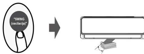
Horizontalni otvor će se automatski pritisnut gore i dolje kad pritisnete tipku "SWING (oscilacija)". Ponovno pritisnite da se zaustavi.
